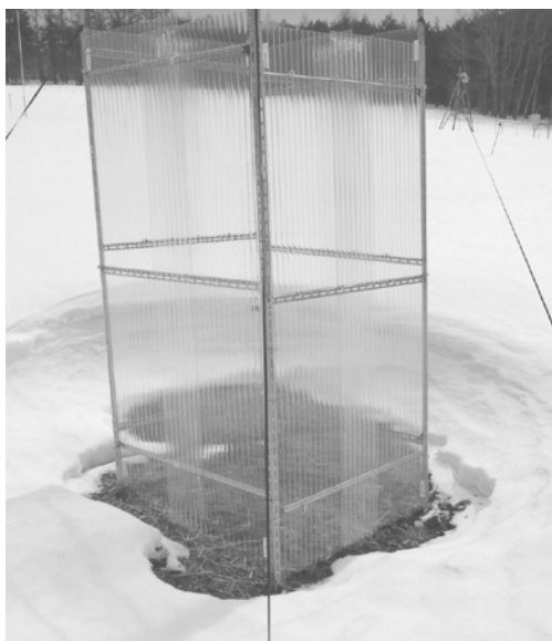
筑波大学菅平高原実験センター内の草原に設置した温暖化装置
