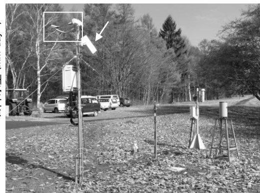
図2 菅平高原実験センターに設置した天気計(□部)とレーザー式積雪深計(矢印)
